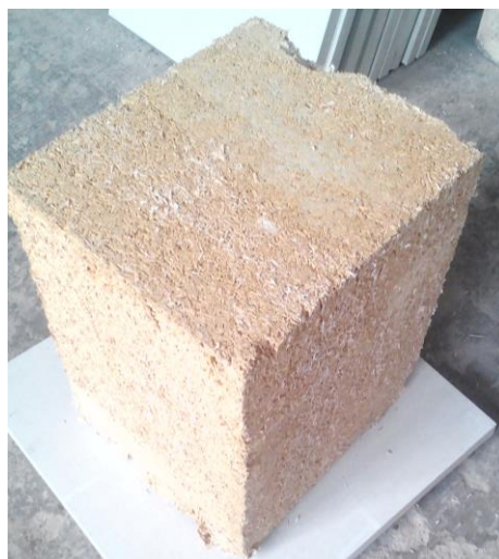
Fig. 4. Epruveta realizată prin Procedeeul de realizare a pereților neporanți tip SuperCalco HEMPCRETE
